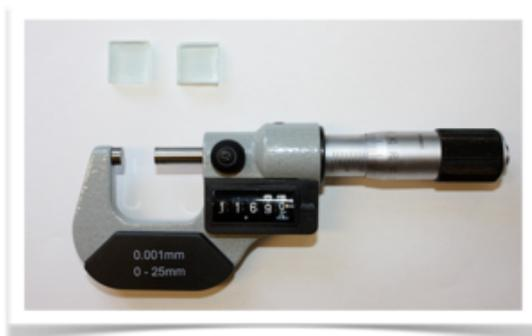
Abb. IV 1 Mikrometerschraube mit den Glasplatten zur Filmdickenmessung
