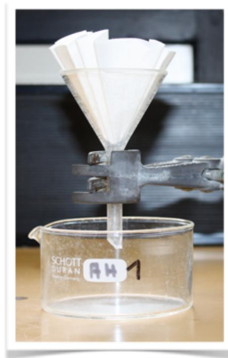
*Abb. IV 12 Darstellung der Filtrationsapparatur zur Ermittlung der Löslichkeit der Testsealer*
