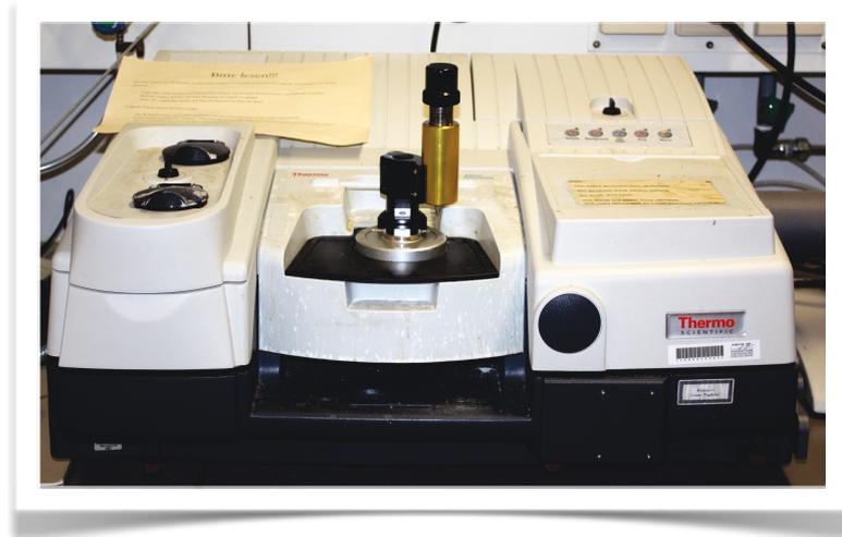
Abb. IV 10 *Infrarotspektrometer zur spektroskopischen Darstellung des Reaktionsablaufs der beiden Pasten eines Epoxidharz-Basis Sealers*
