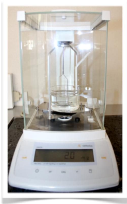
Abb. IV 4 Dichtebestimmungsset Sartorius® zur Ermittlung der Dichte der Probekörper
