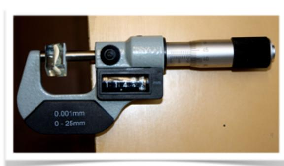
Abb. IV 2 Messung der Filmdicke der Testsealer mit der Mikrometerschraube
