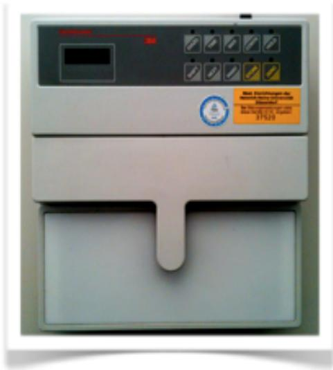
Abb. IV 8 Densitometer® zur Ermittlung der optischen Dichte der Testmaterialien
