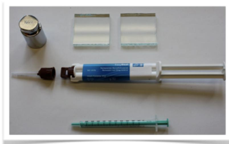
Abb. IV 3 Materialien zur Ermittlung der Fließfähigkeit von EasySeal®
