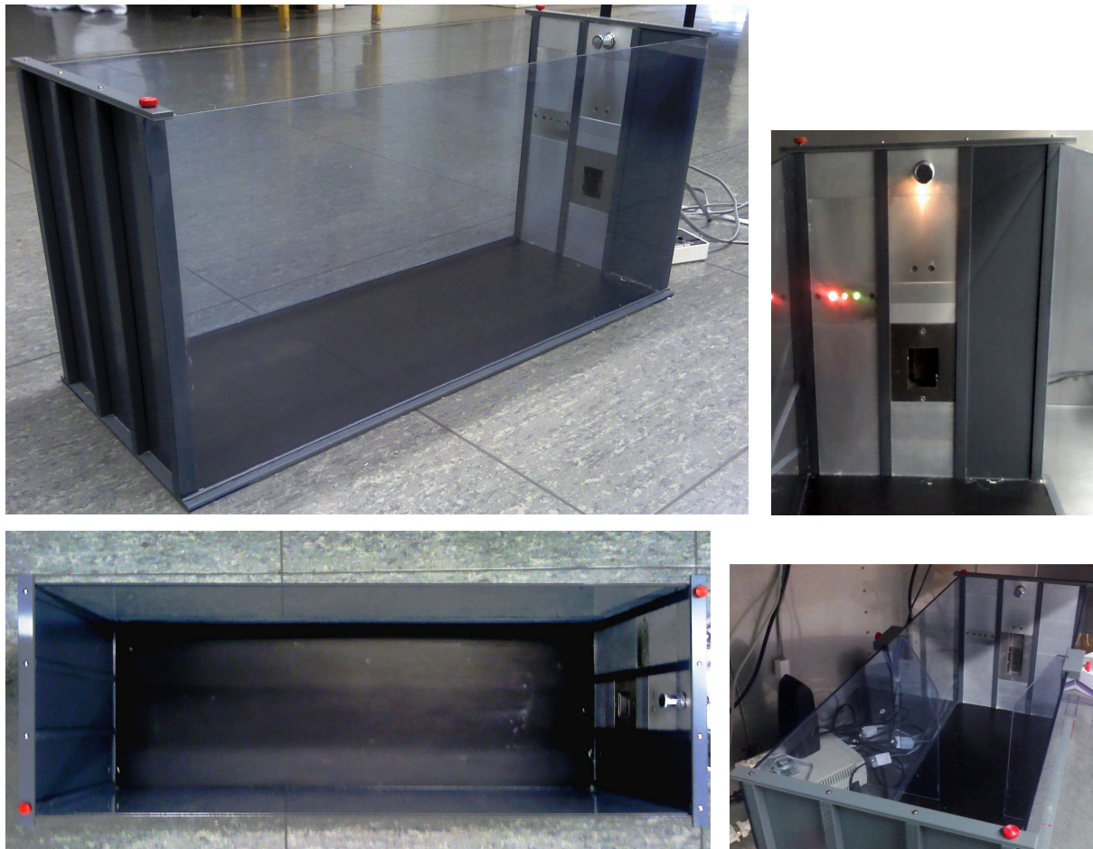
Abbildung 2. Gezeigt ist die Seitenansicht der verlängerten Kammer (oben links) sowie eine Aufsicht von oben (unten links). Zu erkennen ist mittig die Futterluke, links davon das Hinweislicht, sowie am oberen Ende die Beleuchtungseinheit der Apparatur (oben rechts). Für Experiment III wurden mittig Trennwände aus Kunststoff angebracht (unten rechts).
