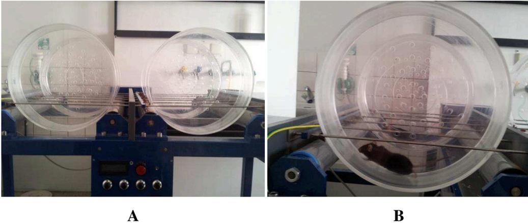
**Abbildung 2.1:** A Darstellung der Laufmaschine. B 4 C57BL/6-Mäuse liefen parallel in rotierenden Walzen der Laufmaschine.
