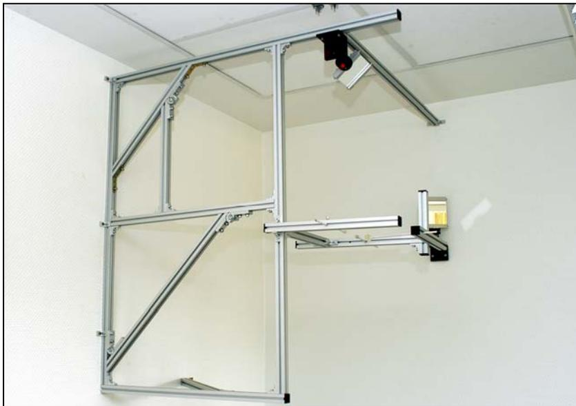
*Abbildung 24: Kephalostat und Spiegelkonstruktionen*
