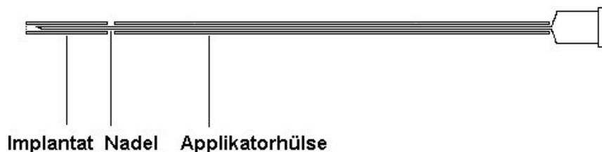
**Abbildung17: Troicar Applicator System zur Fremdkörperimplantation**
