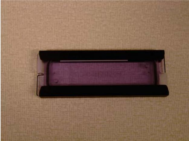
Abbildung 3: *Corning* Hybridisierungskammer geschlossen
