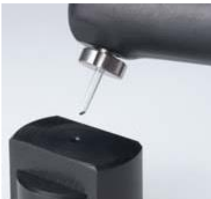
Abb. 4.7a: Die Approx-Sonde und der Vorrichtung zur Eichung des Gerätes
