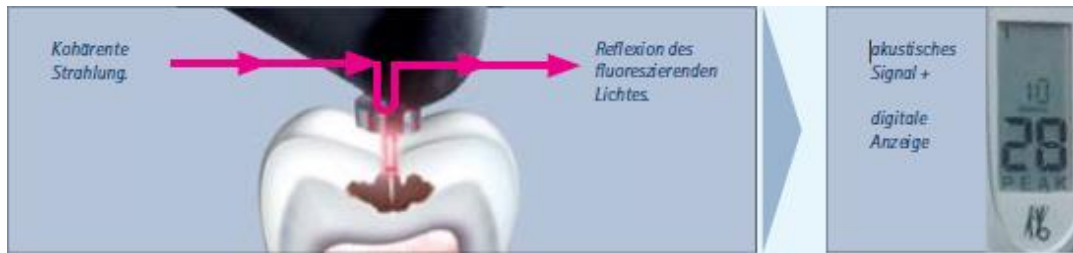
Abb. 4.4: Das Funktionsprinzip des DIAGNOdent pens. (mit freundlicher Genehmigung entnommen aus DIAGNOdent pen 2190 Produktkatalog, Fa. KaVo, 2006).
