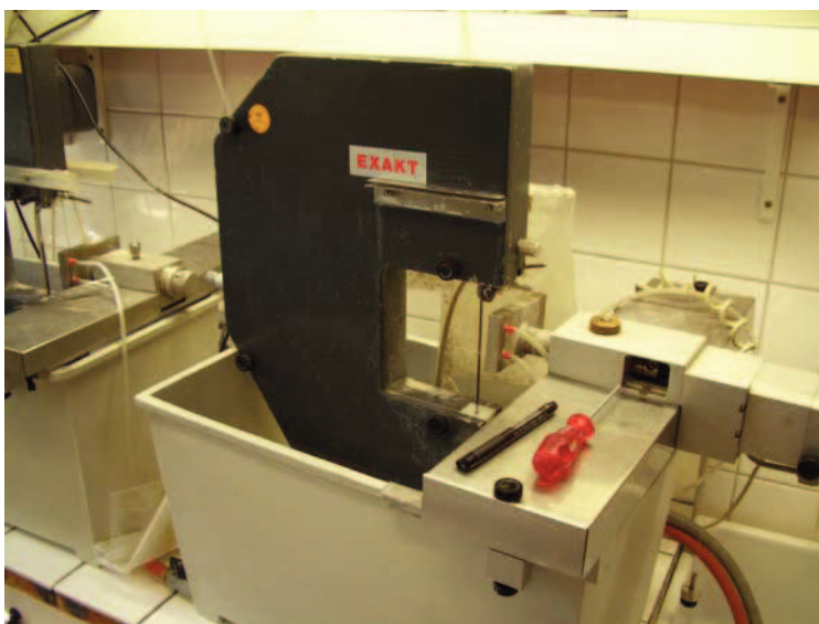
Abb. 10 Diamantbandsäge der Firma Exakt
