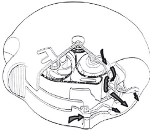
Abbildung 2-7: Aufbau Diskus ® (modifiziert nach Chrystyn (2007)).
