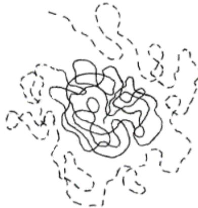
**Abbildung 1-2:** Blockcopolymermicelle in einem selektivem Lösungsmittel. Der unlösliche Block ist von dem solvatisierten Block umgeben
