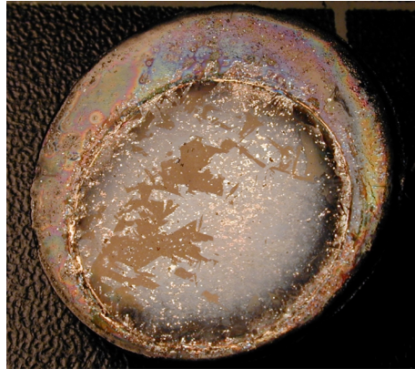
Abb. 80 Mikroskopisches Bild der gealterten Grobkornprobe, deutlich sind die einzelnen Körner zu erkennen.
