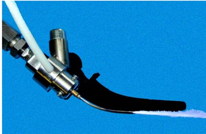
**Abbildung 47:** gekrümmter Fokus zum optimalen Strahlen und Abtragen an der Prothese entlang
