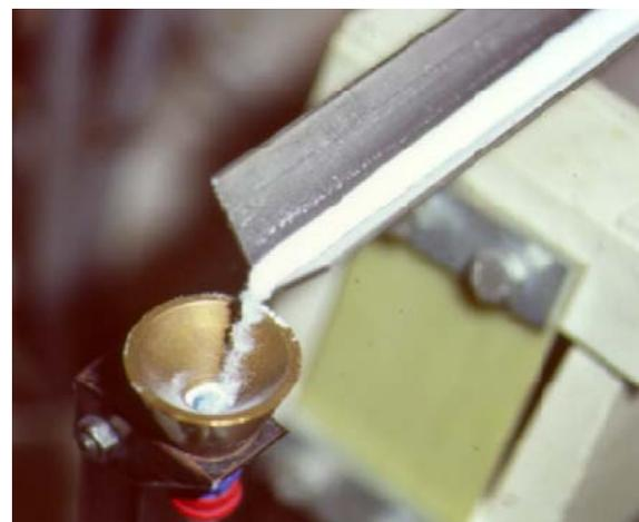
**Abbildung 8:** Vibrationsdosierer mit Abrasive
