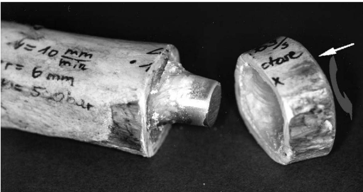
**Abbildung 45:** Kreisschnitt an Modellprothese (500 bar WAIS, Abrasivstoff Laktose, 10 mm/min) mit einer Kerbtiefe von ca. 10 mm, die durch das Absetzen des rechten Knochenringes dargestellt wurde (weißer Pfeil: Strahlrichtung; grauer Pfeil: Vorschub)
