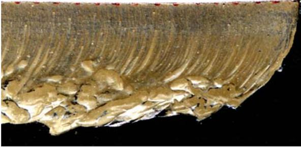
**Abbildung 37:** ADWS-Kerbschnitt mit im Kerbgrundbereich deutlich sichtbaren Aushöhlungen in Technovit® 4004
