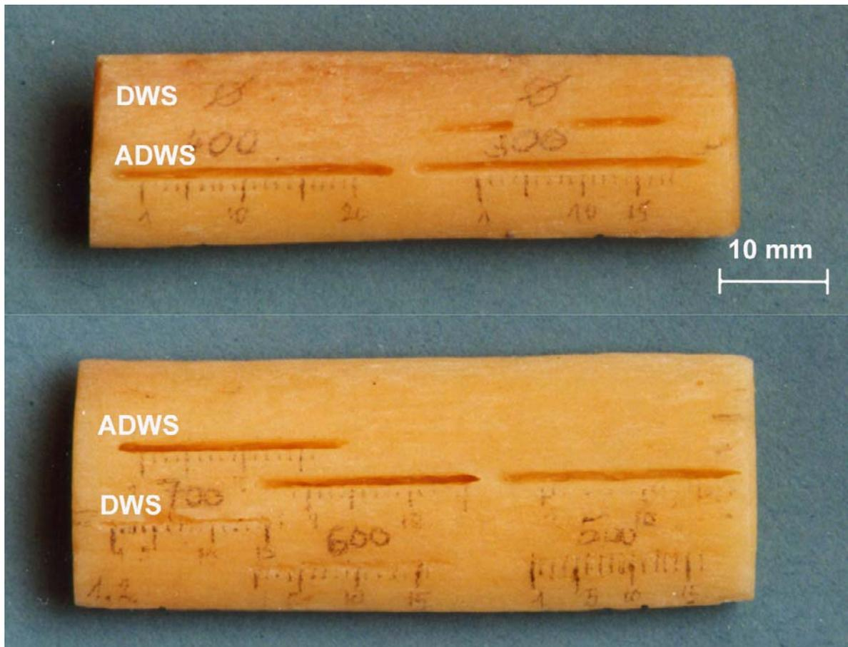
**Abbildung 23:** Kerbschnitte in humaner Compacta mit DWS und ADWS bei  $\gamma = 90^\circ$  (Drücke [bar] direkt über bzw. unter jeweiligem Kerbschnitt):
