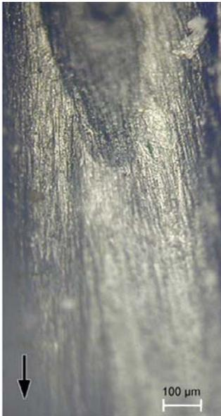
**Abbildung 35:** Schnittfront in Technovit mit Schleifspuren durch primären Abtrag (Auflichtmikroskopie)
