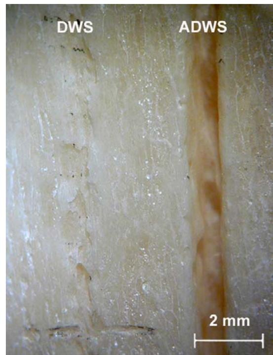
**Abbildung 26:** Auflichtmikroskopie zweier Kerbschnitte (DWS/ADWS) bei 600 bar und  $\gamma = 90^\circ$  in Compacta
