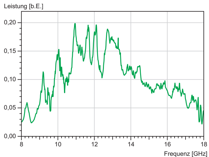
Abbildung 2.3: Seitenbandintensität in Abhängigkeit von der Mikrowellenfrequenz [Fre96]. Die Effizienz der Seitenbänderzeugung liegt im Promille-Bereich. Die spektrale Struktur wirkt sich direkt auf die Größe der Abklingsignale aus.
