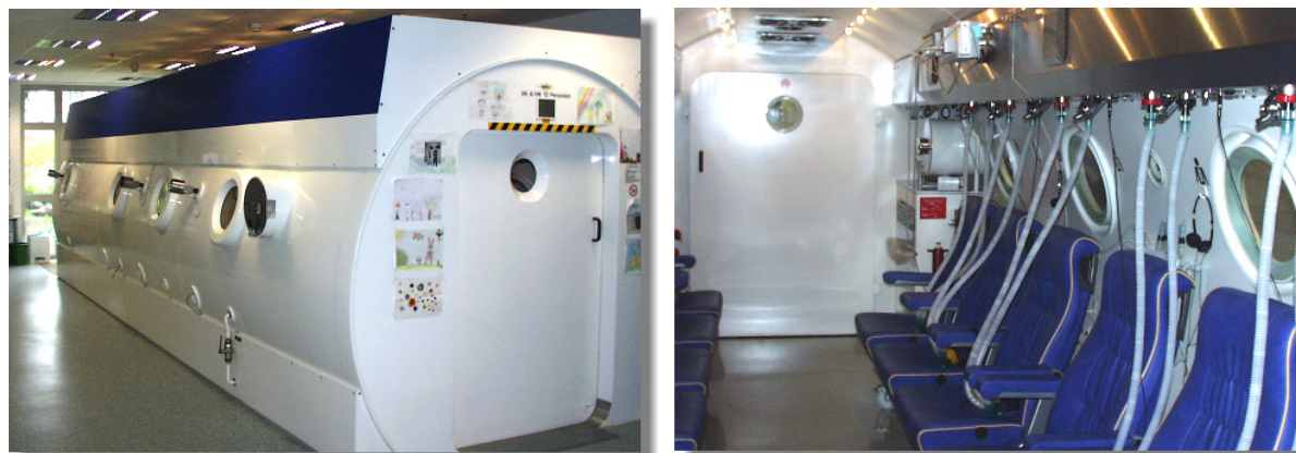
Abbildung 2.19: Druckkammer am Institut für die hyperbare Sauerstofftherapie. In der Kammer können bis zu 12 Patienten gleichzeitig oder ein Patient im Krankhausbett behandelt werden. An jedem Platz steht über eine Atemmaske der Sauerstoff zur Verfügung. Die Behandlungen finden bei einem Druck von 2 bis 2,8 bar statt.
