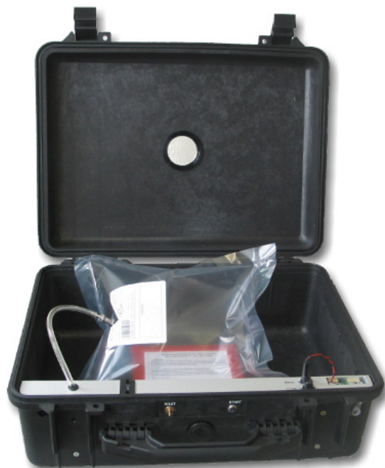
Abbildung 2.10: VacuCase ® für das berührungslose Sammeln von Raumluftproben. Mit einer batteriebetriebene Vakuumpumpe wird im Koffer ein Unterdruck erzeugt, durch den sich der Probenbeutel mit Außenluft füllt. Hersteller: Analyt-MTC. Maße: 49×39×17 cm. Gewicht: 5,2 kg.
