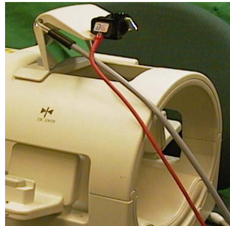
Abb. 3: Beispiel einer Kopfspule zur Verwendung im MR-Tomographen, hier mit System zur Analyse der gemischten Bewegungen
