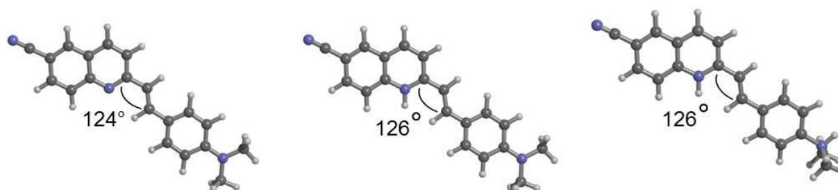
**Abbildung 43:** Optimierte Geometrien auf B3LYP-6-311G\*\*-Niveau für unprotonierte, einfach protonierte und doppelt protonierte Spezies von (*E*)-2-(4-(Dimethylamino)styryl)chinolin-6-carbonitril (**28c**).
