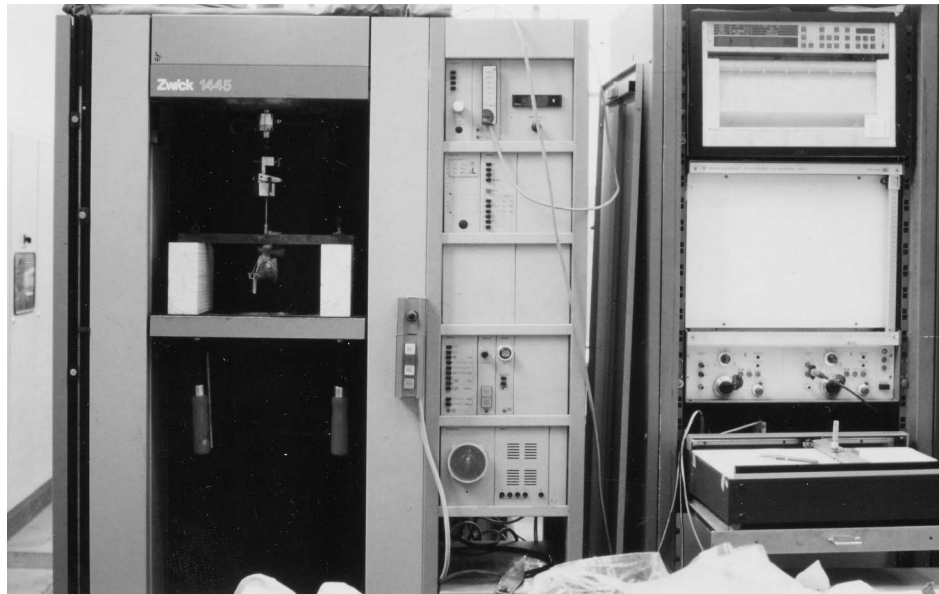
Bild 18: Auszugskraftermittlung mit Materialprüfmaschine ZWICK 1445
