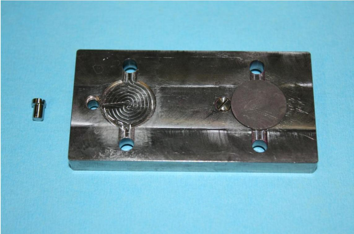
**Abbildung 4: Ansicht des speziell zur Durchführung dieser Versuche entwickelten und angefertigten Plättchenfixateurs.**
