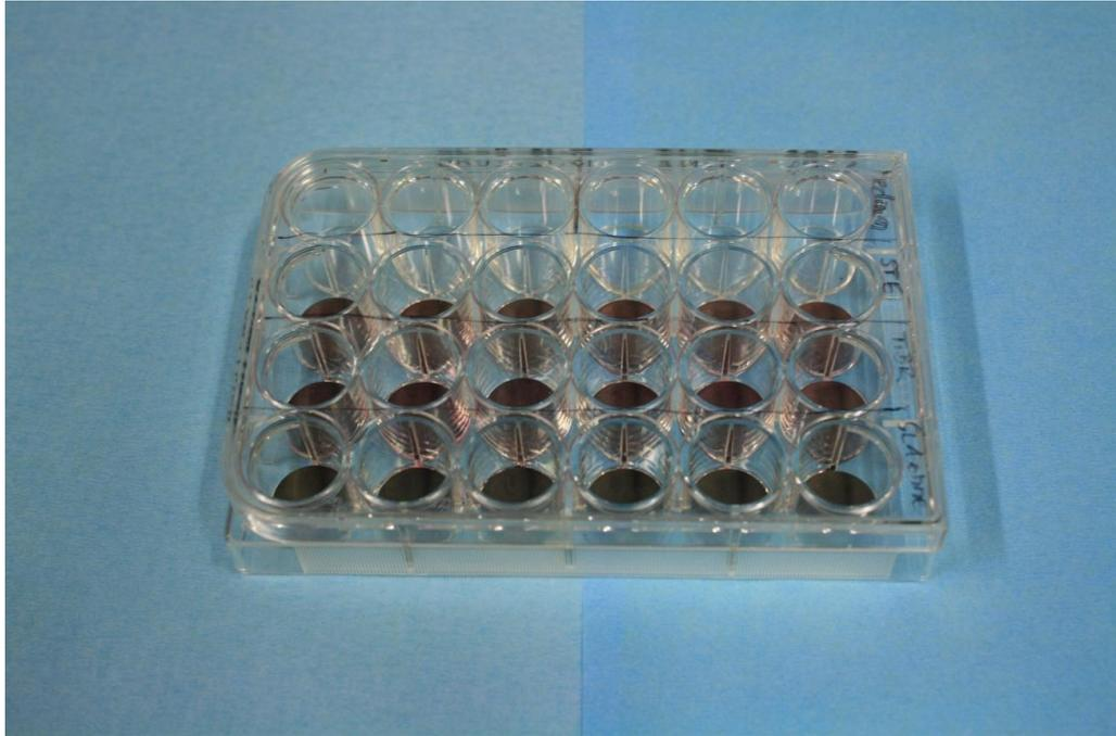
**Abbildung 5: Beispiel einer mit den Probekörpern beladenen 24-Well-Zellkulturplatte zur Viabilitätsmessung**
