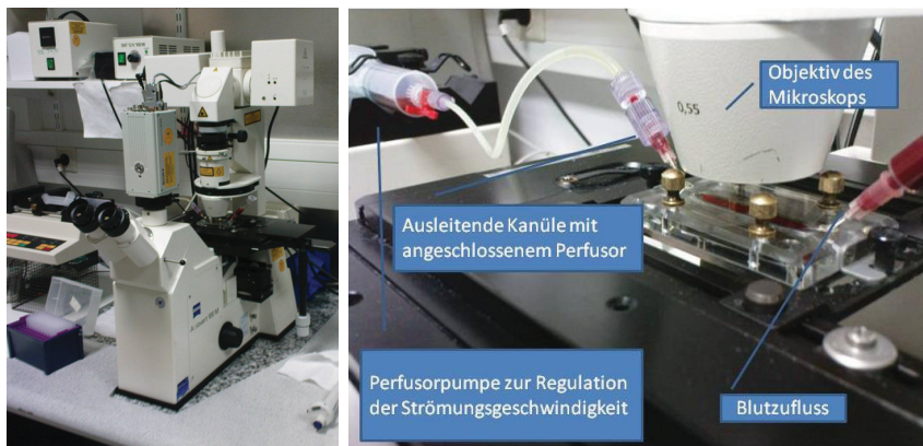
Abb. 2.3: Übersichtsaufnahme mit Mikroskop und Perfusor (links) sowie Detailansicht mit eingesetzter Flusskammer (rechts).
