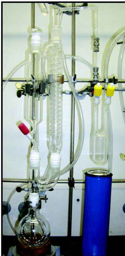
**Abbildung 6.2:** Apparatur für die Synthese von  $(R_F)_3P=O$  durch Reaktion von  $(R_F)_3PF_2$  und  $((CH_3)_3Si)_2O$ .
