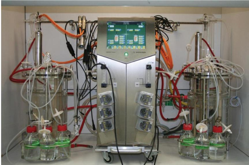
**Abbildung 2.1:** 10 | Glasfermenter mit Wasserbad, pH-Messgerät, Säurepumpen und Stickstoffbegasung.
