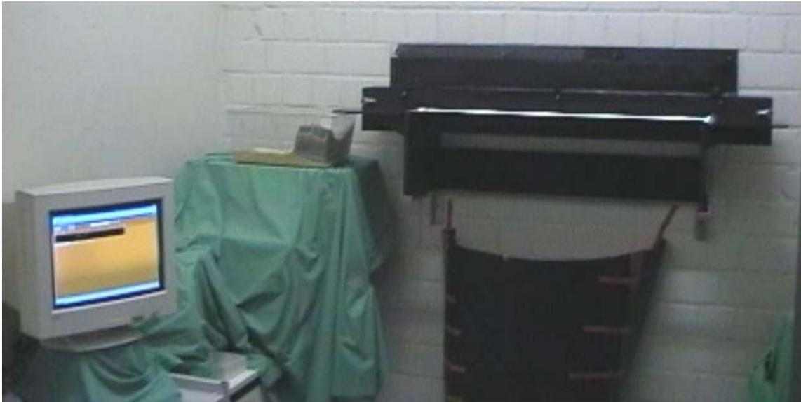
Abb. 2.5: CatWalk Apparatur zur Untersuchung des Laufes auf einer ebenen Fläche. Die Box am Ende dient der Motivation zum Überqueren der 1 m langen Laufstrecke.
