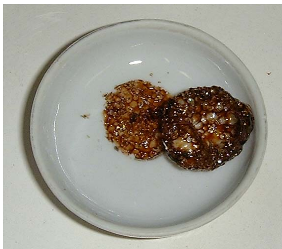
Abb. 55: Poly( N -octylmethacrylimid) ( 29a ), welches durch Thermolyse in einem Trockenschrank hergestellt wurde
