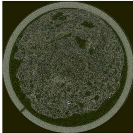
Abb. 53: Eine der Schichtaufnahmen durch Poly( N -ethylmethacrylimid), die für die dreidimensionale Darstellung aufgenommen wurde
