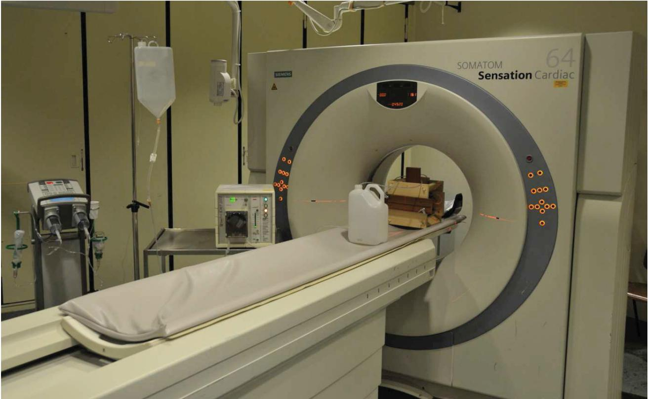
**Abbildung 3:** Versuchsaufbau im CT-Scanner (von links nach rechts): Doppelkopf-Injektor für KM, Infusionsständer mit Reservoir mit sauberem Wasser (zufließendes Blut), Sellink- / Rollerpumpe (Herz). Im Scanner: Kanister als Reservoir für abfließendes KM-haltiges Wasser, Prototyp des Perfusionsphantoms (aktuelles Phantom ohne Halterahmen aus Holz; siehe Fotos oben).
