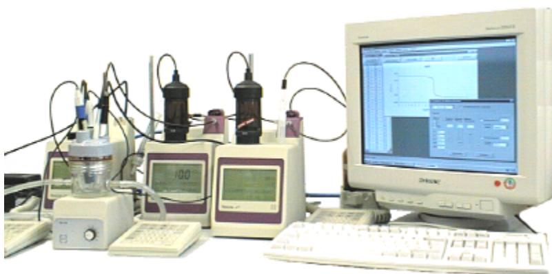
**Abbildung 7.1:** Messapparatur zur Durchführung potentiometrischer Titrations
