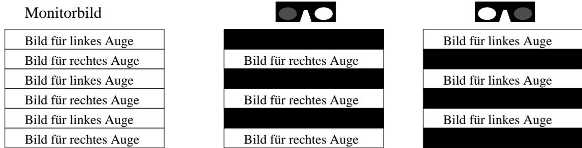
Abbildung 4.33: Lineblanking-Verfahren
