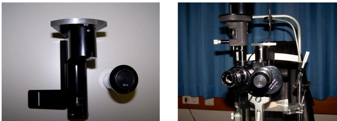
Abb. 8: Spaltlampenaufsatz zur Bestimmung der Hornhautdicke (Haag-Streit)
