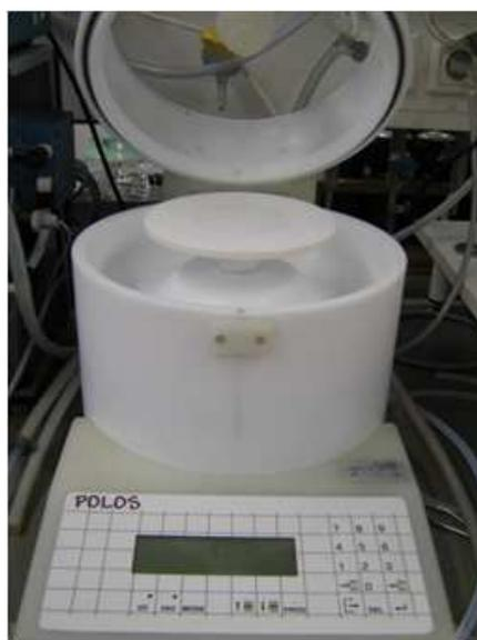
Abb. 4.8: Spin-Coater des Typs Wafer Spinner der Firma Polos, der in dieser Arbeit verwendet wurde.
