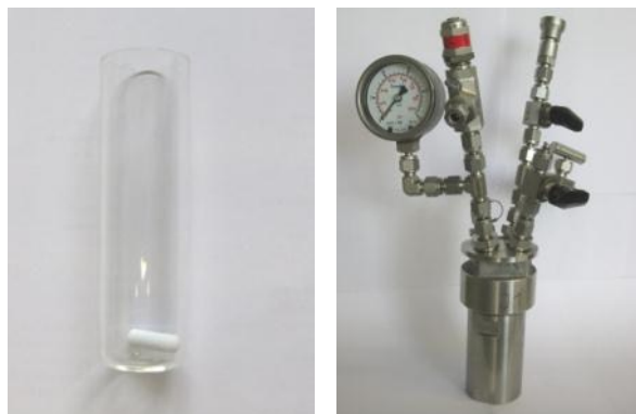
Abb. 80: Links: Zylindrische Glashülse mit Magnetrührstab. Rechts: Edstahlautoklav.
