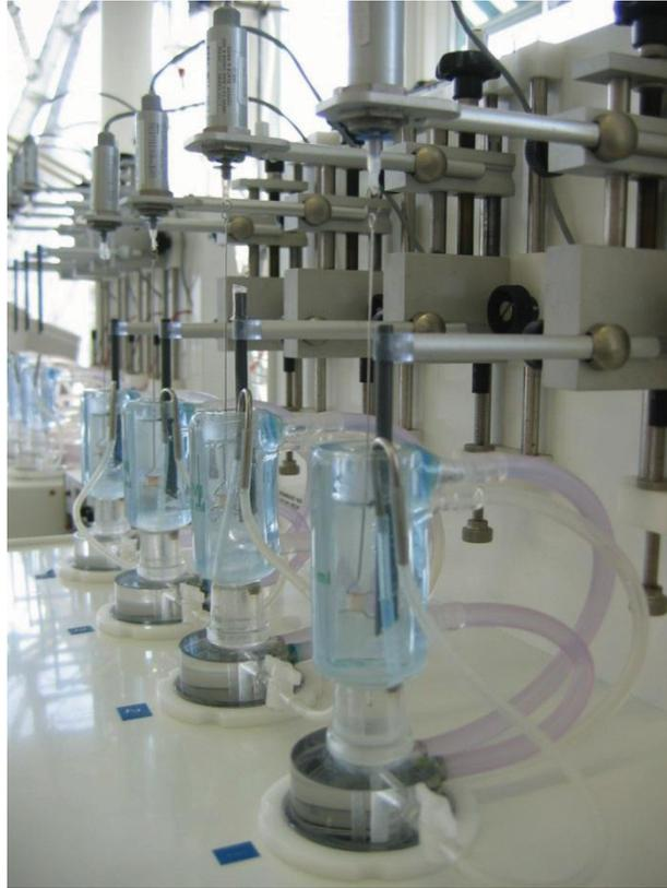
**Abb. 3:** Für die Messungen standen jeweils vier Organbäder mit einem Füllungsvolumen von 10 ml zur Verfügung (Details s. Text).
