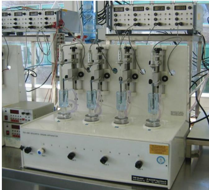
**Abb. 2:** Die Versuchsapparatur verfügte über je vier Organbäder. Der funktionelle Zustand der untersuchten Venenringe wurde über die entsprechenden Kraftaufnehmer untersucht.
