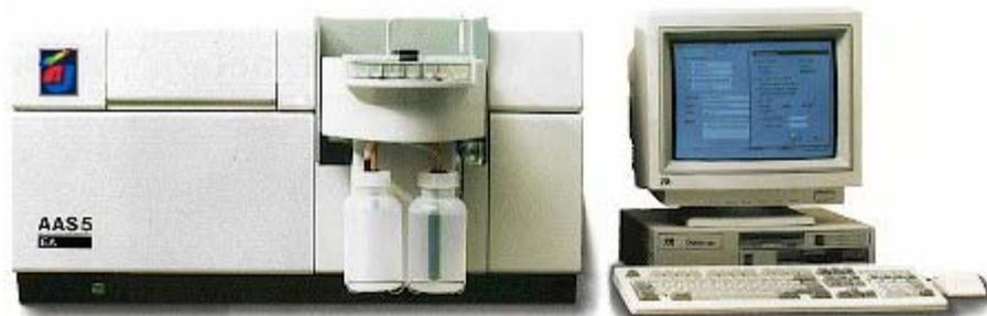
Abb. 8: Graphitrohr - AAS 5 EA, CARL-ZEISS-TECH. Vollautomatisches Atomabsorptionsspektrophotometer zur Ultrapurenanalytik an Realproben mit komplizierter Matrix.
