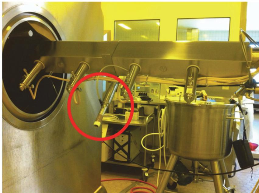
**Abbildung 3-38: Versuchsaufbau für in-line Messungen im BFC 400: Sondenbefestigung am Sprüharm (optimierte Halterung)**
