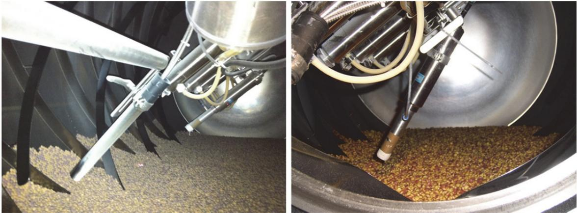
**Abbildung 3-37: Versuchsaufbau für in-line Messungen im BFC 400: Sondenbefestigung am Sprüharm (links: Prototyp, rechts: optimierte Halterung)**
