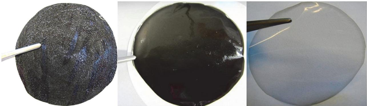
**Abbildung 4-4:** CNT-Hybridmembranen; links: in dieser Arbeit funktionalisierte MWNT-COOH, mitte: kommerzielle MWNTs, rechts: gemörserte SWNTs (kommerziell).
