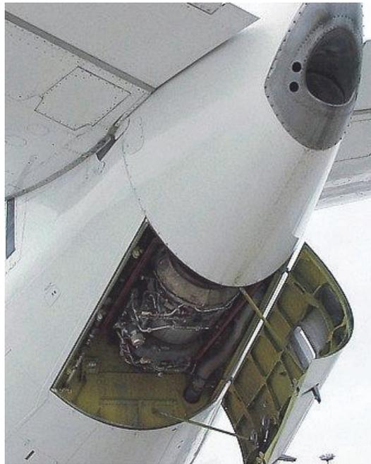
**Abbildung 2-3:** Auxiliary Power Unit (APU) eingebaut im Heck eines Flugzeuges [13].
