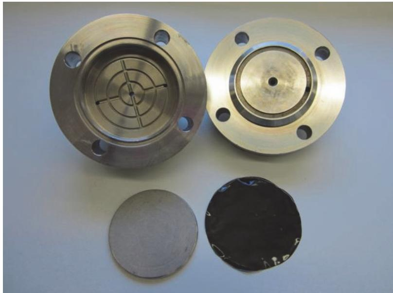
**Abbildung 4-20:** Trennzelle, Edelstahlplatte und eine CNT-Hybridmembran.
