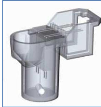
**Abb 2:** Testzelle mit 2 Elektrodenpaaren und Rührstab
