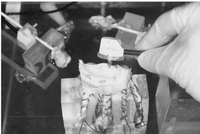
Abb.3.2.2: Benutzung des vierten Sensors am Beispiel des Radius. Zur Digitalisierung der Gelenkoberfläche wurden viele Meßpunkte auf der Gelenkfläche des Knochens erhoben. Anschließend erfolgte die Berechnung des geometrischen Zentrums zur Ermittlung des Koordinatensystems des
