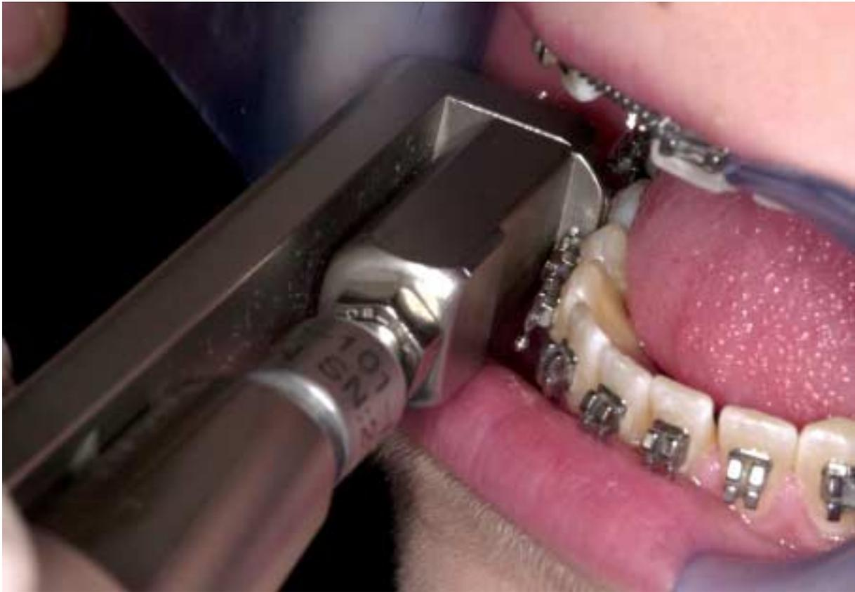
**Abbildung 2-5: Die Abbildung zeigt den Einsatz der Messapparatur am Patienten (zur besseren Darstellung wurde für dieses Photo die hygienische Schutzhülle entfernt)**
