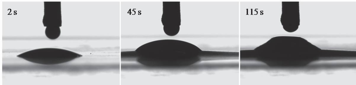
Abbildung 74: Tropfenkonturanalyse (Abschnitt 6.6) der Drucksuspension mit Tadalafil auf dem Trägerfilm; Aufnahmen nach 2 s, 45 s und 115 s
