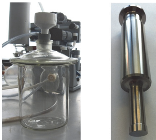
Abbildung 36: Tropfverfahren und Stempeldruck im Labormaßstab (Abschnitt 6.3.1.3); links: Büchnertrichter zum Fixieren der ODFs; rechts: Tablettenstempel als Druckwerkzeug
