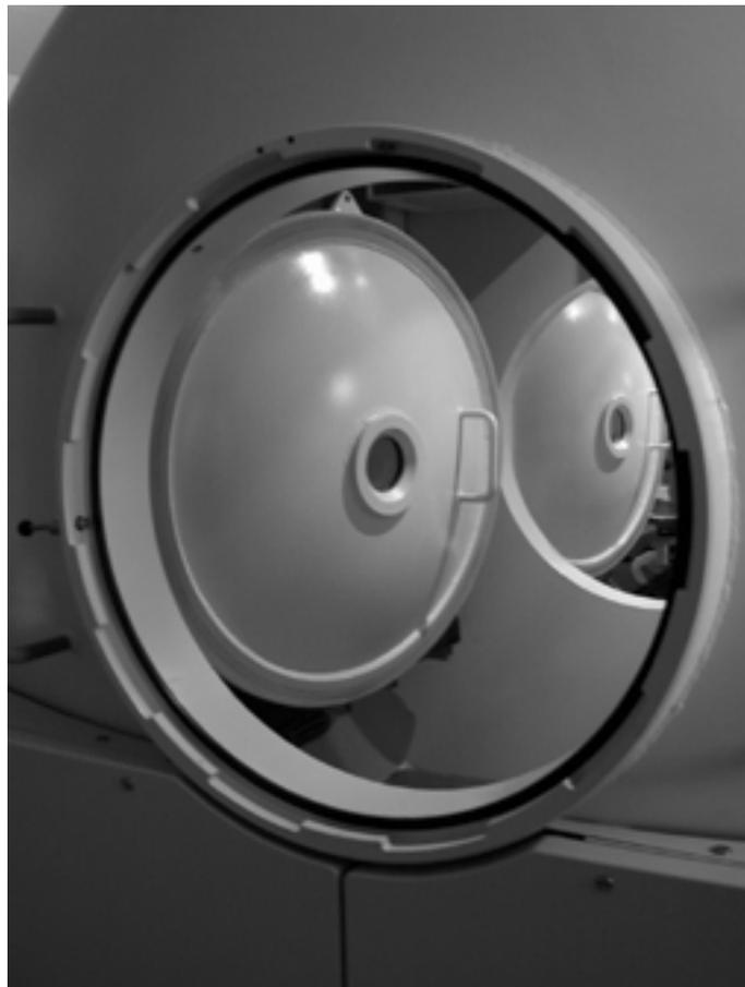
**Abbildung 5: Natoflansch zum Andocken einer Transportkammer; die geöffneten runden Türen erlauben einen Blick in die Vor- bzw. Hauptkammer**
