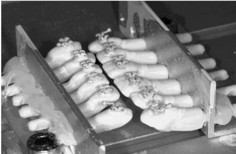
Abb. 27: Mit Brackets beklebte Zähne in einer Halterung auf dem Verschiebetisch
