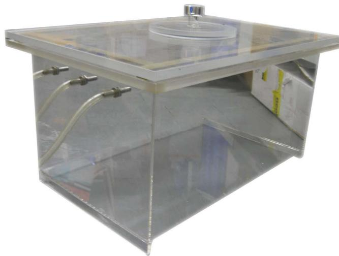
Abbildung 3.2: verwendete Plexiglaschamber zur Erzeugung einer normobaren Hypoxie, Hersteller: Feinmechanische Werkstatt der Heinrich – Heine Universität Düsseldorf. Quelle: selbst.
