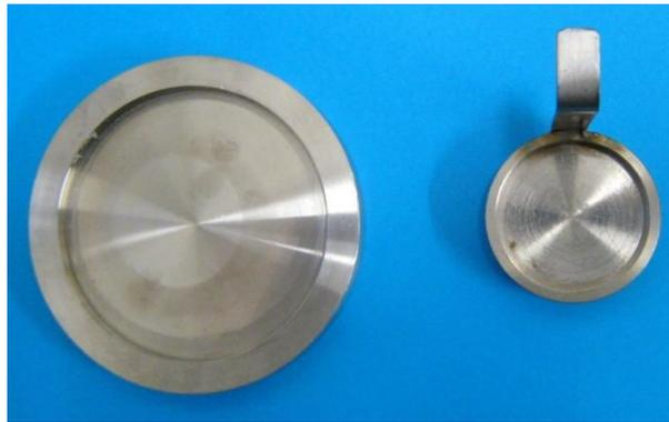
**Abb. 4.7:** Ausgießschalen für Polymerschmelzen oder Lösungen aus Edelstahl zur Herstellung von Membranen.
