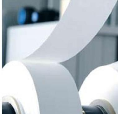
**Abb. 3.2:** Abbildung eines im letzten Produktionsschritt zur Rolle aufgewickelten Separion® Separators<sup>[53]</sup>.
