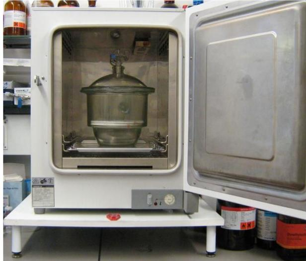
Abb. 4.6: Ofensystem, welches eine Polymerisation unter Argon ermöglicht.
