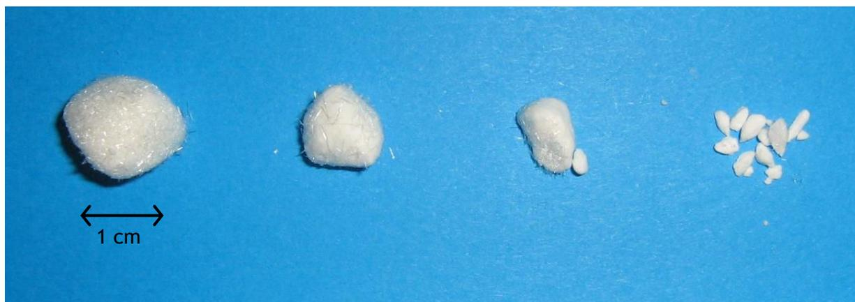
Abb. 4.5: Exemplarische Darstellung der unterschiedliche Bulkgrößen, welche zur NMR-Analyse herangezogen wurden.
