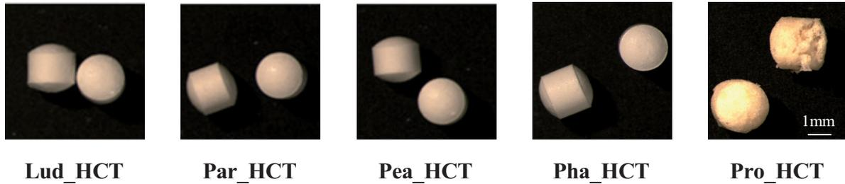
Abbildung 13. Photographische Aufnahmen der ODMTs mit HCT, Presskraft: 5,5 kN (Pea\_HCT: 8 kN) nach 6 Monaten offener Lagerung unter Stressbedingungen (40°C/75 % r.F.)
