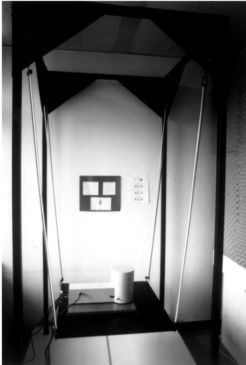
Abbildung 3-5: Eigenbau-Schwingungsdämpfung für das verwendete SPM
