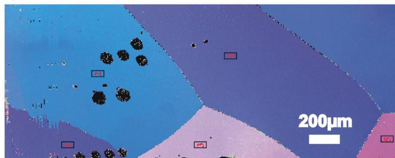
**Abbildung 3-1: EBSD-Orientierungskarte eines gewalzten, elektroplierten Ta-Blechs (Fa. ALDRICH) vor und nach der Rekristallisation nach verschiedenen Verfahren**
