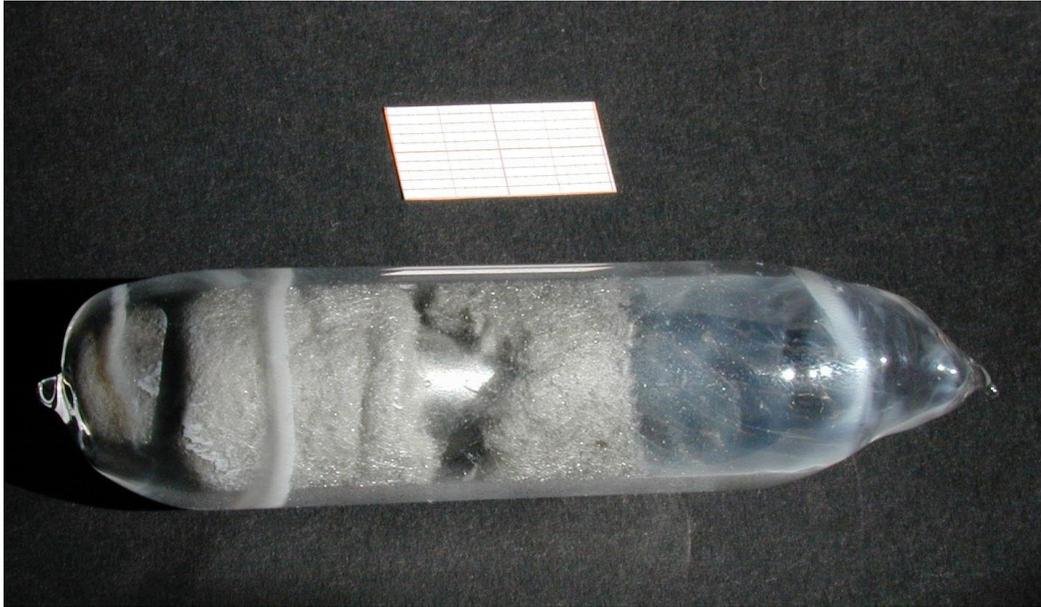
**Abbildung 3-2: Quarzampulle (Länge 9cm) mit in Keramikwolle gewickelten Zr-Stab nach der Temperaturbehandlung.**
