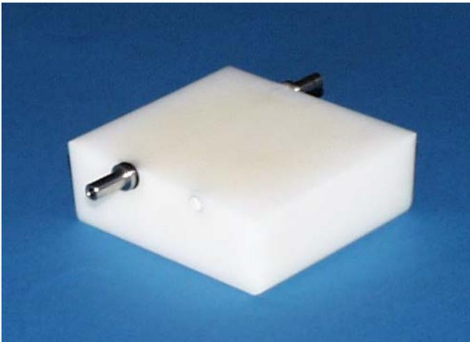
**Abbildung 4.14:** Fotografie des Festkörperphantoms mit zylindrischer Bohrung. An den Enden der Bohrung befinden sich Tüllen zum Anschluss von Schläuchen.
