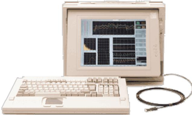
**Abbildung 5.20:** Das LEA O2C erlaubt eine Messung von Gewebeparametern mittels NIR-Spektroskopie und Laser Doppler Fluxmetrie. Quelle: [63]
