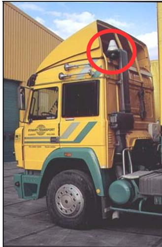
Abbildung 30 INMARSAT-Antenne für Landverkehrsanwendungen <sup>53</sup>
