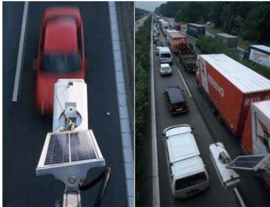
Abbildung 44 DDG-Brückensensor zur Erfassung von Verkehrsinformationen <sup>70</sup>
