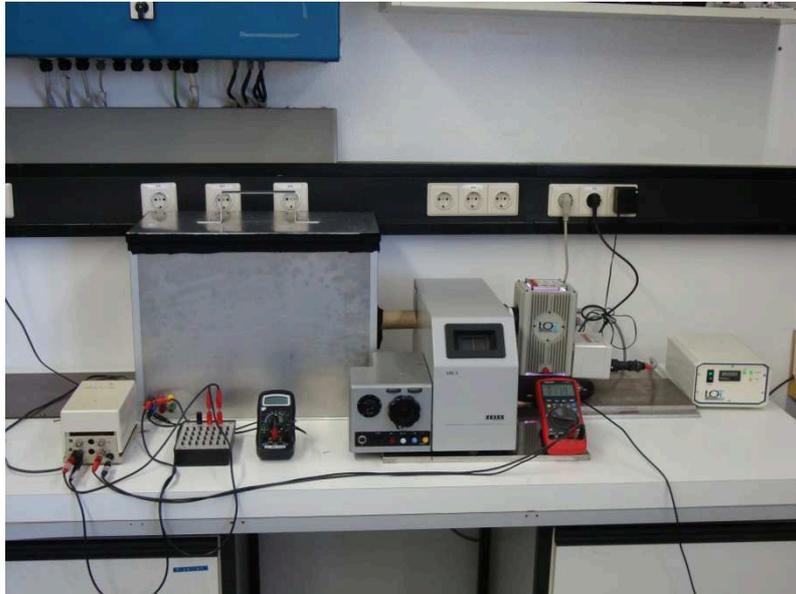
Abbildung 3.11: Aufbau für die Aufnahme von IPCE-Spektren.
