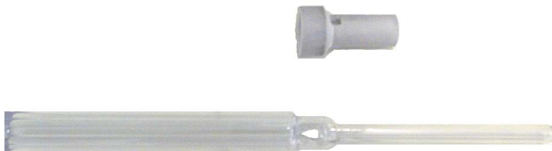
Abbildung 7: Einsatz mit Spinner für einen 10 mm Probenkopf zur Durchführung NMR-kontrollierter Titrations
