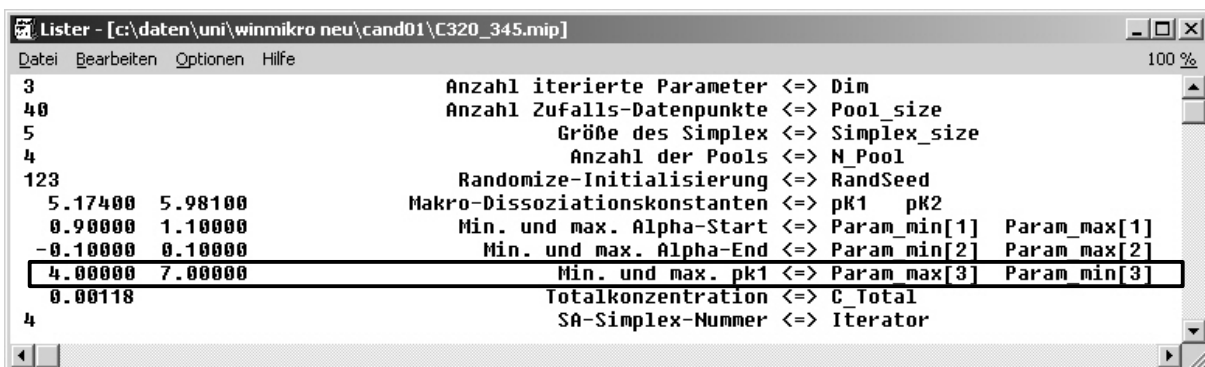
Abbildung 4.3: Exemplarische WINMIKRO-Datei mit MikroIteratorParametern (hier für den Scan „Absorption gegen V_Z “ bei Diodenposition „320,345nm“). Die Iterationsgrenzen für den ersten Mikro-pk sind weit gesteckt. Sie lauten: Untergrenze = 4,0 und Obergrenze = 7,0.
