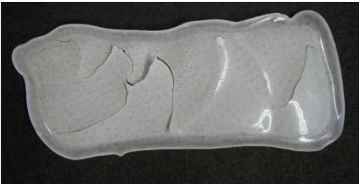
**Abb. 19b:** In Phosphatpuffer pH 5 gequollener Eudragit<sup>®</sup> L100-55-Film (2 h, 37°C) nach Trocknung über Blaugel, Größe des Filmstücks: ~5x2 cm<sup>2</sup>
