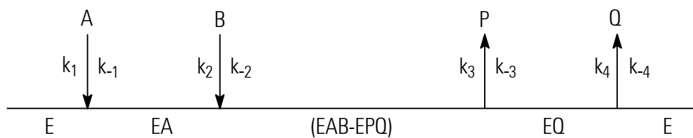
Abbildung 6: Reaktionsschema der Ordered Bi-Bi-Kinetik der Candida boidinii -FDH. NAD (A), Formiat (B), CO 2 (P), NADH (Q), Enzym (E).
